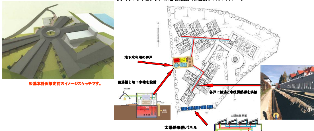
リタイアメントビレッジの地域給湯・冷暖房システムイメージ
