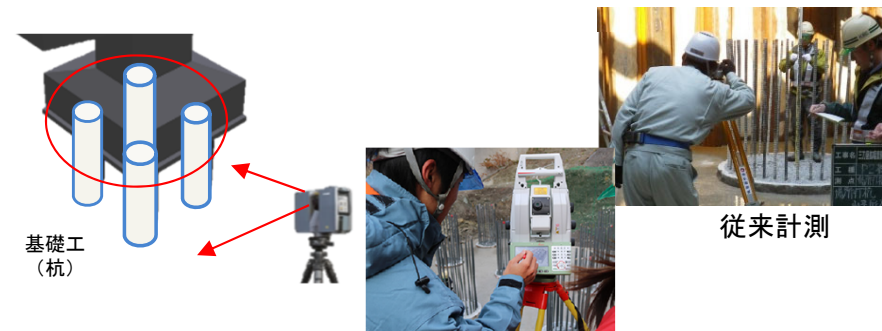
TLSを用いた場所打ち杭の出来形計測
