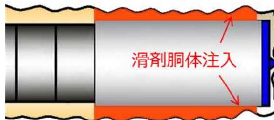
シールド機胴体注入の概念図
