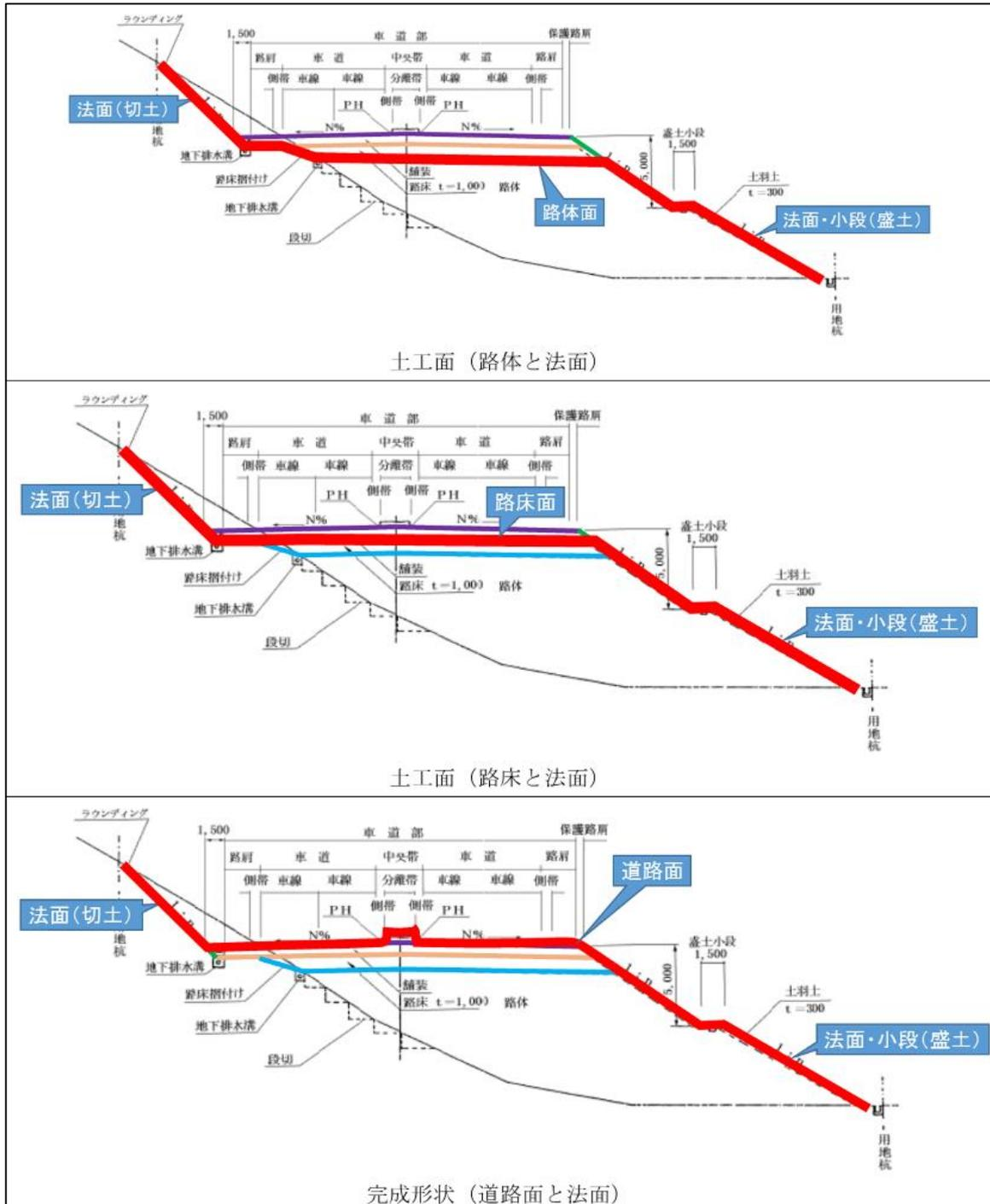
道路分野で情報化施工に必要な断面
